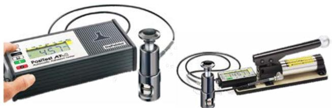
Existen 2 tipos de equipos portátiles hidráulicos, uno manual y otro automático, ambos también se encuadran en la norma de la ABNT, como A3 – Dispositivo de Accionamiento Hidráulico.
