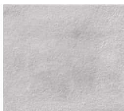
CSP 1 – Ataque ácido 685,8 µm*
