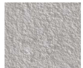
CSP 5 – Granallado medio 1676,4 µm*
