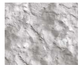
CSP 10 – Marteteo de concreto de mano seguido de granallado abrasivo 6350 µm*
