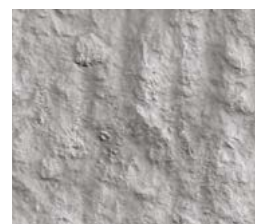
CSP 9 – Escarificación (fresa) pesada 5435,6 µm*
