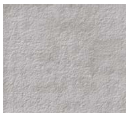
CSP 3 – Granallado leve 965,2 µm*
