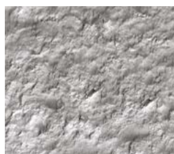
CSP 8 – Pulimiento con insertos de acero o de widia 5334 µm*
