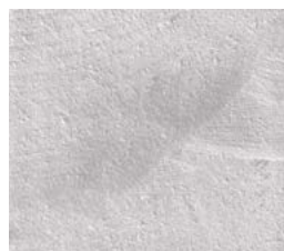
CSP 2 – Pulimiento con piedras 812,8 µm*
