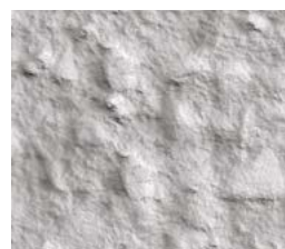
CSP 7 – Granallado pesado 4445 µm*
